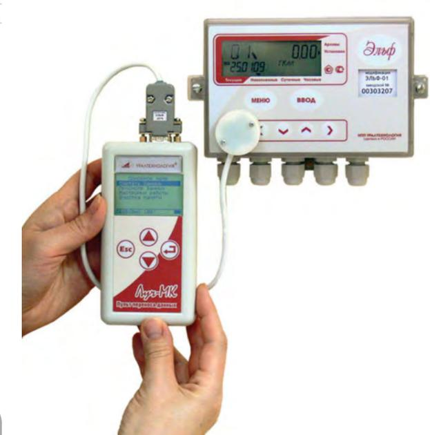
Приборы ЭЛЬФ наделены возможностью сбора и переноса данных различными устройствами в зависимости от предпочтений пользователя. Вывод данных на компьютер обеспечивают оптопорт и встраиваемые модули RS-232, RS-485, M-bus, токовая петля. Например – Сбор данных с вычислителей ЭЛЬФ через оптопорт с помощью переносного пульта ЛУЧ-МК. Приборы линии ЭЛЬФ позволяют строить автоматизированные системы сбора данных.
